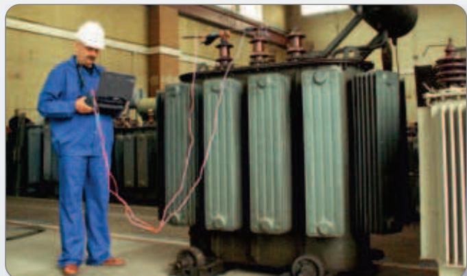
Před zahájením měření je nutné vybrat otočným přepínačem maximální měřicí proud z rozsahu od 0,1 mA do 10 A. Měřicí rozsah a tedy i proud je vybíráno ručně nebo automaticky. V některých případech (např. překročení přípustného výkonu emitovaného na objektu) může být žádoucí omezit maximálního proudu protékajícího zkoumaným objektem. MMR-620 má blokaci, která umožňuje nastavení horní přípustné hodnoty měřicího proudu.
