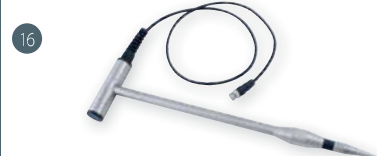
GSF 50 (110 cm) obj. č. 601305 GSF 50K (43 cm) obj. č. 601308 zapichovací snímač (bez teplotního senzoru), pro měření do hloubky 40 cm popř. 107 cm, včetně 1 m připojovacího kabelu, určen pro štěpku, dřevitou vlnu, třísky, seno, slámu, obilí, piliny atd.
